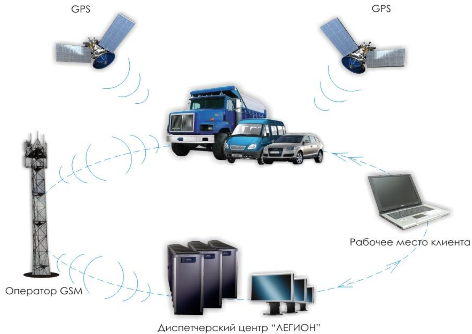
Рис.1.3. Схема работы программно-аппаратного комплекса «ЛЕГИОН-2».
